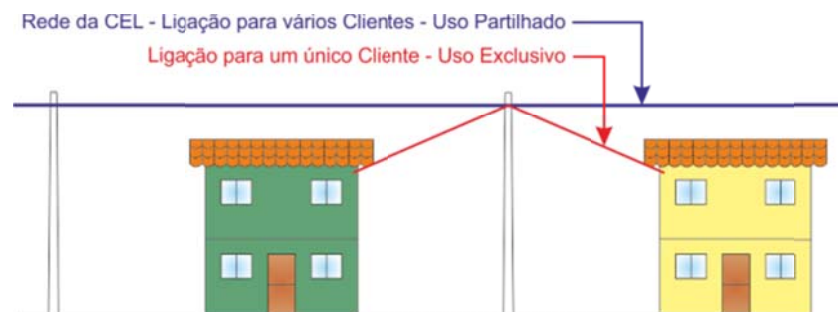
Figura 1 – Exemplo de uso exclusivo e uso partilhado em rede aérea
