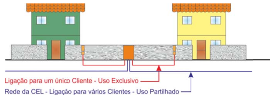
Figura 3 – Exemplo de uso exclusivo e uso partilhado em rede subterrânea
